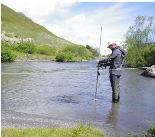
Prise de mesures grâce à un courantomètre (vitesse, débit) sur le Doron de Belleville.
